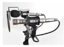
Стереопара ВМ-882m состоит из двух инструментальных конденсаторных микрофонов ВМ-88m, двух антивибрационных креплений SMP-4 с интегрированными РОР-фильтрами и двух ветрозащитных фильтров. В микрофонах используются конденсаторные капсюли с мебраной диаметром 25мм. Эти микрофоны характеризуются низким уровнем собственных шумов, бестрансформаторным выходом, качественным предусилителем, высокой чувствительностью и широким динамическим диапазоном. Микрофоны из набора ВМ-882m могут
