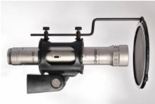
Профессиональный конденсаторный микрофон BM-88m оснащен капсюлем с диафрагмой диаметром 25 мм, обеспечивающей кардиоидную характеристику направленности. Микрофон обладает высокой чувствительностью, широким частотным диапазоном, малыми искажениями, низким уровнем собственных шумов. Благодаря встроенному подключаемому аттенюатору и фильтру верхних частот, микрофон позволяет эффективно подавлять посторонние шумы и уменьшать выходной сигнал для источников громких звуков.
